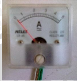
Gambar 3.7 Amperemeter Sumber: Dokumentasi pribadi
