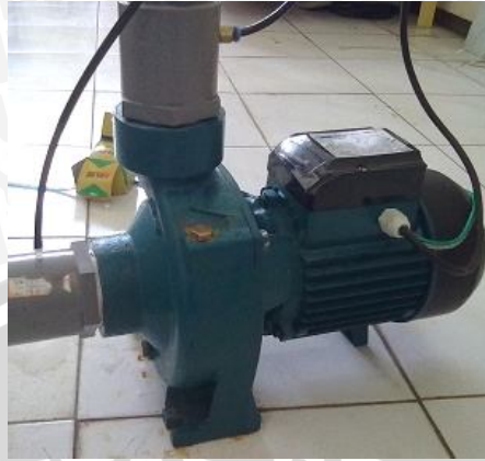
Gambar 3.5 Pompa sentrifugal Sumber: Dokumentasi pribadi
