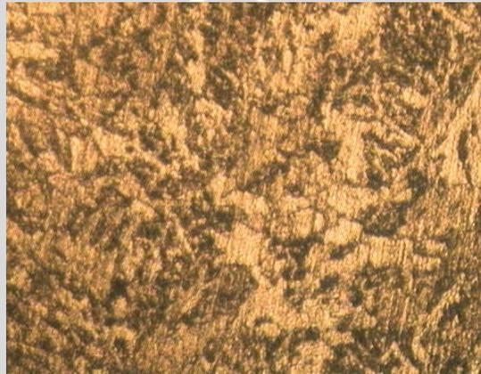
Gambar 4.2 Hasil foto mikrostruktur daerah *weld metal*
