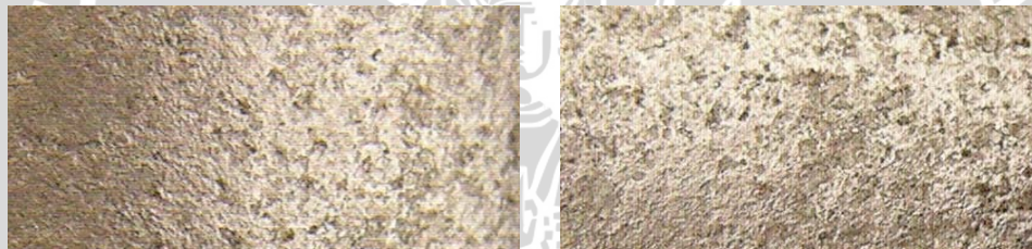
Gambar 4.14 Spesimen baja AISI 1045 setelah elektroplating nikel dengan jarak anoda dan katoda 13 cm
