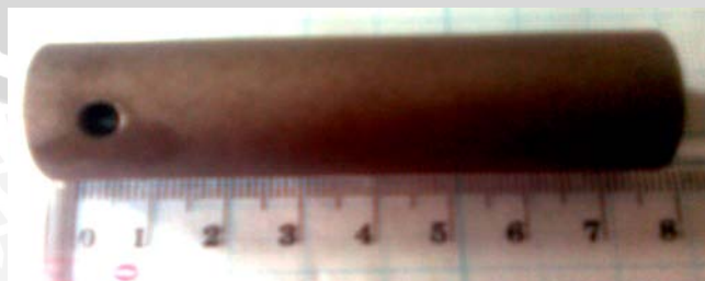
Gambar 4.3 Spesimen baja AISI 1045 setelah di sand blasting dengan resolusi 1024 x 768 pixels
