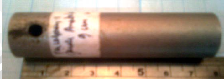
Gambar 4.11 Spesimen baja AISI 1045 setelah elektroplating nikel dengan jarak anoda dan katoda 9 cm, resolusi 1024 \times 768 pixels.
