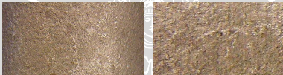
Gambar 4.12 Spesimen baja AISI 1045 setelah elektroplating nikel dengan jarak anoda dan katoda 9 cm.
