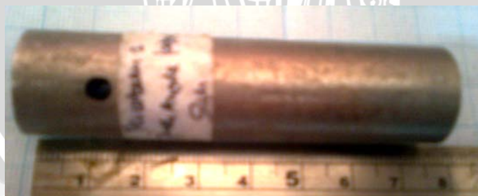
Gambar 4.7 Spesimen baja AISI 1045 setelah elektroplating nikel dengan jarak anoda dan katoda 5 cm, resolusi 1024 x 768 pixels.
