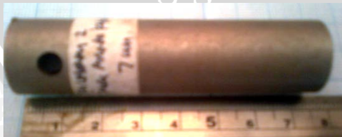
Gambar 4.9 Spesimen baja AISI 1045 setelah elektroplating nikel dengan jarak anoda dan katoda 7 cm, resolusi 1024 x 768 pixels.
