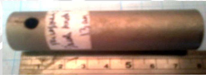
Gambar 4.13 Spesimen baja AISI 1045 setelah elektroplating nikel dengan jarak anoda dan katoda 13 cm, resolusi 1024 x 768 pixels.
