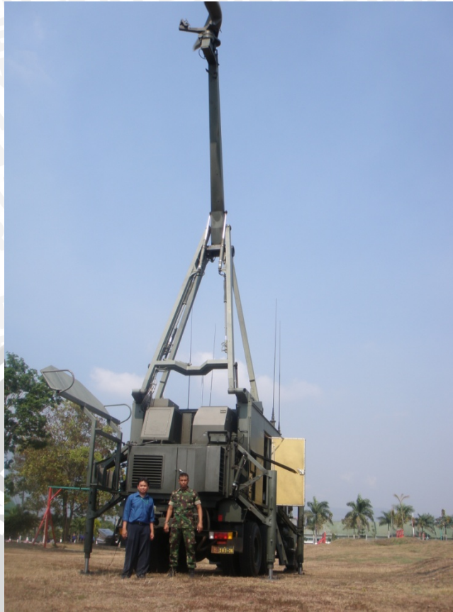
Gambar 2.23 Radar Giraffe yang ditumpangkan pada Truk
