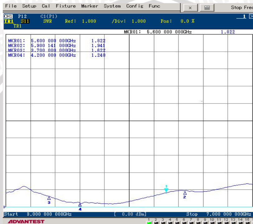
Gambar 5.9 Tampilan pengukuran menggunakan Network Analyzer Advantest R3770
