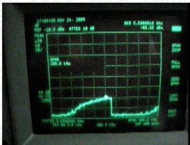
Gambar 5.16. Level penerimaan sinyal carrier ketika pancarannya diatur oleh PRF (Sumber : Hasil Pengukuran)
