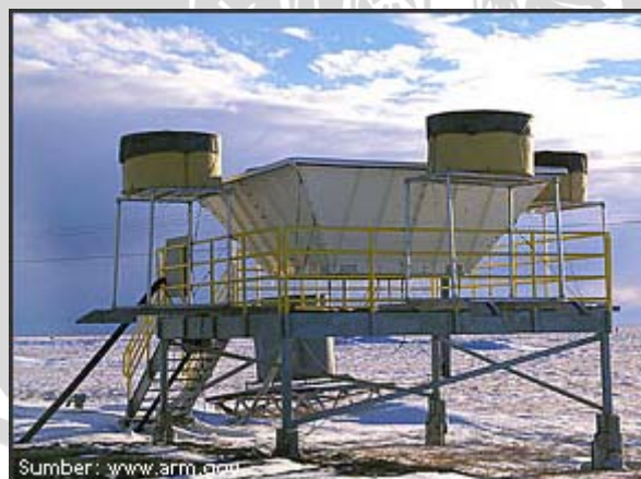
Gambar 2.20 Radar angin (Sumber : www.arm.gov )
