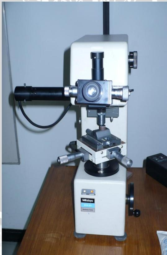
**Mesin Uji Kekerasan Mikro Vickers
