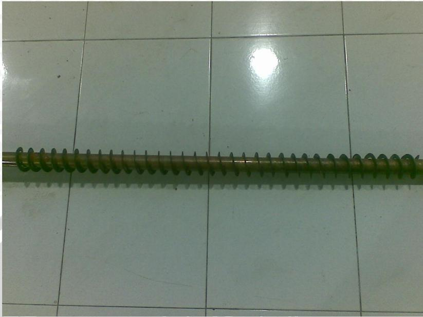
Gambar : Pemasangan *Outer Helical fin* pada *Inner tube*
