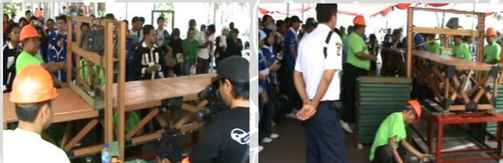
Tes beban untuk menguji lendutan.
