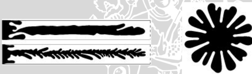
Gambar 2.12 : Pola penetrasi viscous finger ; dari udara (hitam) menuju ke minyak (putih) pada lateral dan radial Hele-Shaw cell
