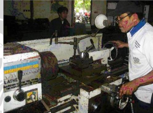
Pembuatan Spesimen Uji Tarik
