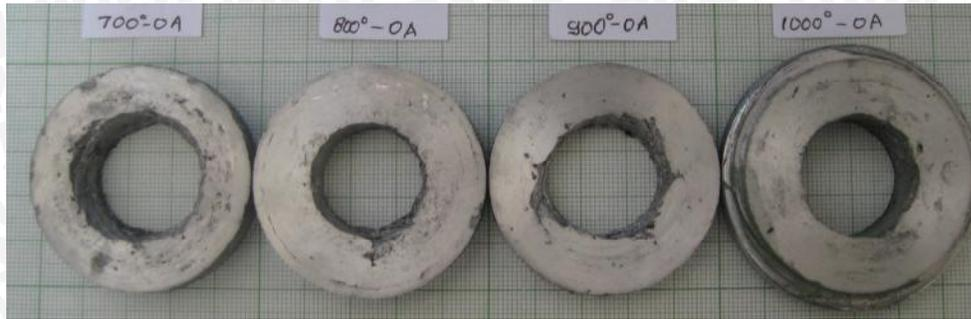
Gambar 4.11 Potongan spesimen pada pada variasi temperatur penguangan sebelum permukaan spesimen dihaluskan
