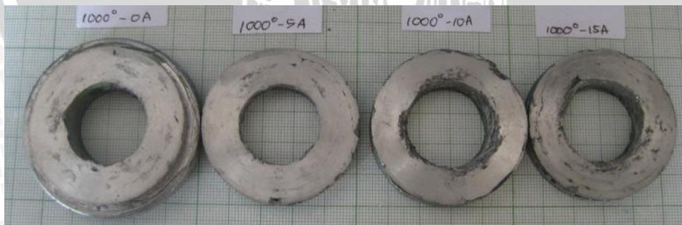
Gambar 4.5 Potongan spesimen pada temperatur penuangan 1000 °C sebelum permukaan spesimen dihaluskan
