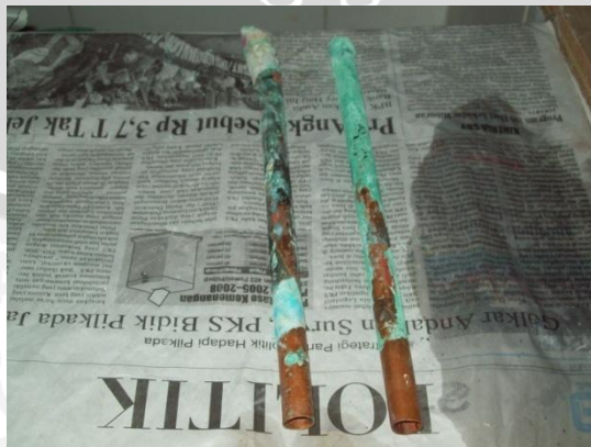
Gambar 4.12 Pipa Anoda yang Korosif
