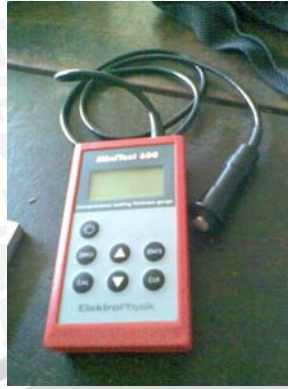
Gambar 2.4 Coating thickness mini Test 600 Type : 12-1605 SN: 9802 Sumber : Lab. Metalurgi Institut Teknologi Sepuluh Nopember Surabaya
