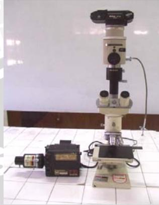
Gambar 3.6. Mikroskop Logam
