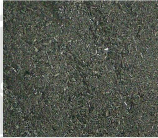
Gambar 3.11. Arang dengan ukuran *Mesh* 280-250  $\mu\text{m}$
