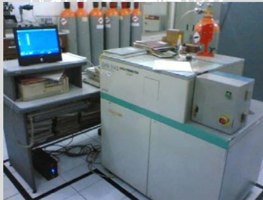
Gambar 3.7 Mesin Spectrometer
