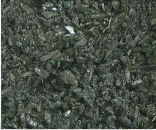
Gambar 3.10. Arang dengan ukuran *Mesh* 560-500  $\mu\text{m}$
