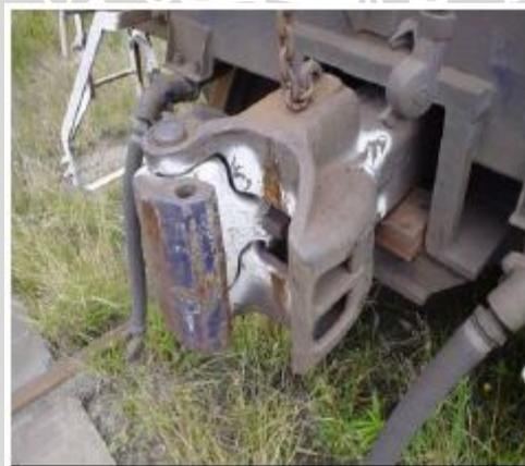
Gambar 2.4 Kopler yang mengalami patah di bagian *knuckle* akibat rambatan retak
