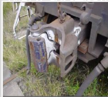
Gambar 2.2 Kopler yang mengalami broken akibat rambatan retak
