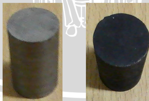
Gambar 3.11. Spesimen uji: (a) Spesimen tanpa perlakuan, (b) Spesimen setelah pack carburizing .
