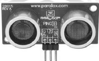
Gambar 2.8. Sensor ultrasonik PING)))
