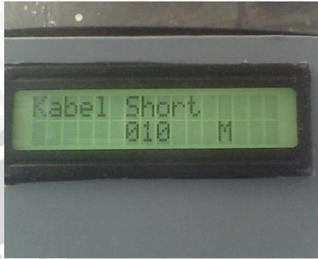
**Gambar 5.10.** Hasil Pengujian Alat Kabel short 10 meter
