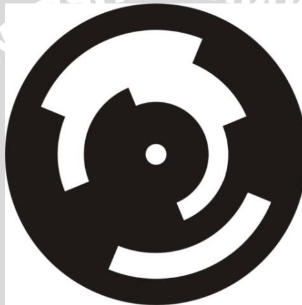
Gambar 4.3 Piringan yang digunakan untuk mendeteksi arah angin
