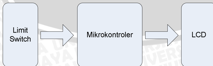
Gambar 5.3 Diagram blok pengujian penghitungan penekanan limit switch
