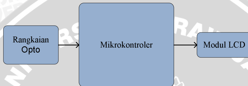
Gambar 5.10 Diagram blok pengujian jumlah pulsa rangkaian opto
