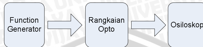
Gambar 5.6 Diagram blok pengujian kecepatan respons sensor opto dalam
