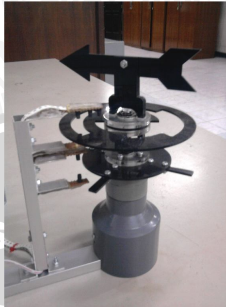
Gambar 2 Pemodelan sensor kecepatan angin dan arah angin
