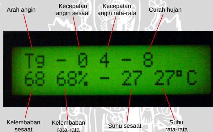
Gambar 5.23 Tampilan nilai data yang dikirim dari RTU ke Base Station
