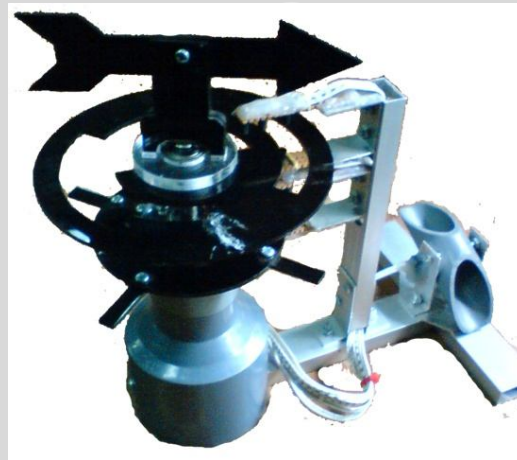
Gambar 4.4 Hasil pembuatan mekanik pemodelan sensor kecepatan angin, arah angin dan curah hujan
