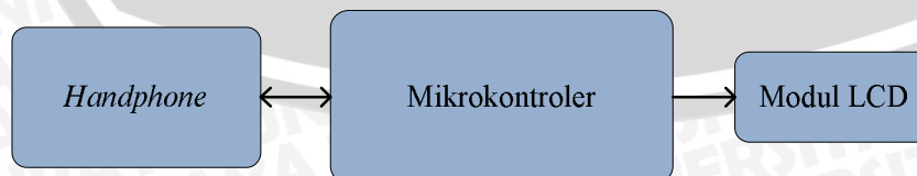
Gambar 5.19 Diagram blok pengujian antarmuka handphone dengan mikrokontroler
