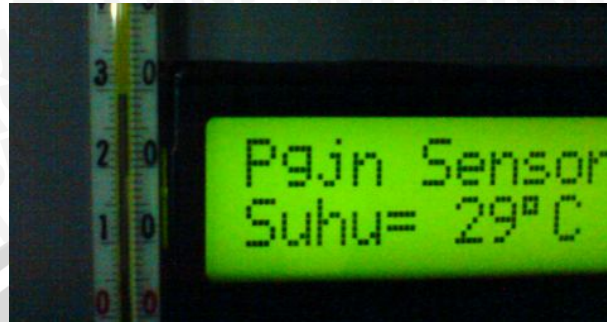
Gambar 5.13 Hasil pengujian pengambilan data suhu dari Modul DT-Sense SHT11
