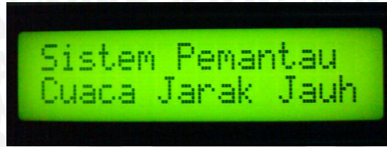
Gambar 5.2 Tampilan hasil pengujian modul LCD
