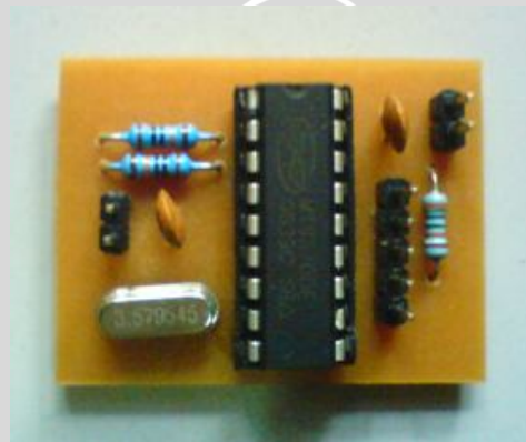
Gambar 4.12 Hasil pembuatan rangkaian DTMF decoder
