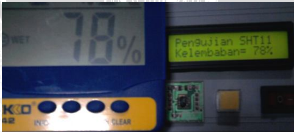
Gambar 5.14 Hasil pengujian pengambilan data kelembaban dari Modul DT-Sense SHT11
