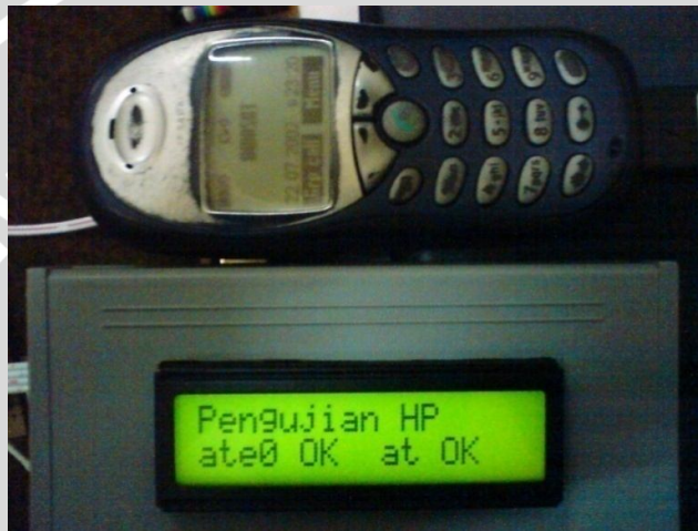
Gambar 5.20 Hasil pengujian antarmuka handphone dengan mikrokontroler
