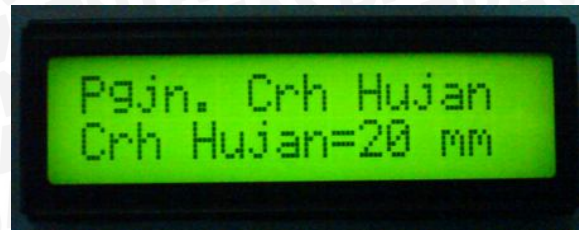
Gambar 5.4 Hasil pengujian penghitungan penekanan limit switch sebanyak 20 kali
