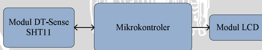
Gambar 5.12 Diagram blok pengujian modul DT-Sense SHT11
