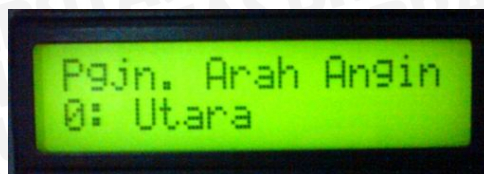
Gambar 5.16 Hasil pengujian pengambilan data pemodelan sensor arah angin
