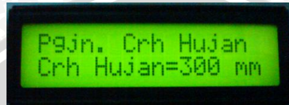
Gambar 5.5 Hasil pengujian penghitungan penekanan limit switch sebanyak 300 kali
