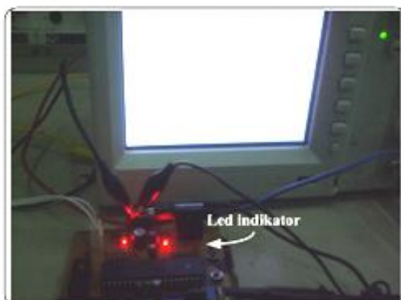
Gambar 5.26 Hasil Pengujian dengan Masukan Sinyal Sinusoida Frekuensi 2800 Hz
