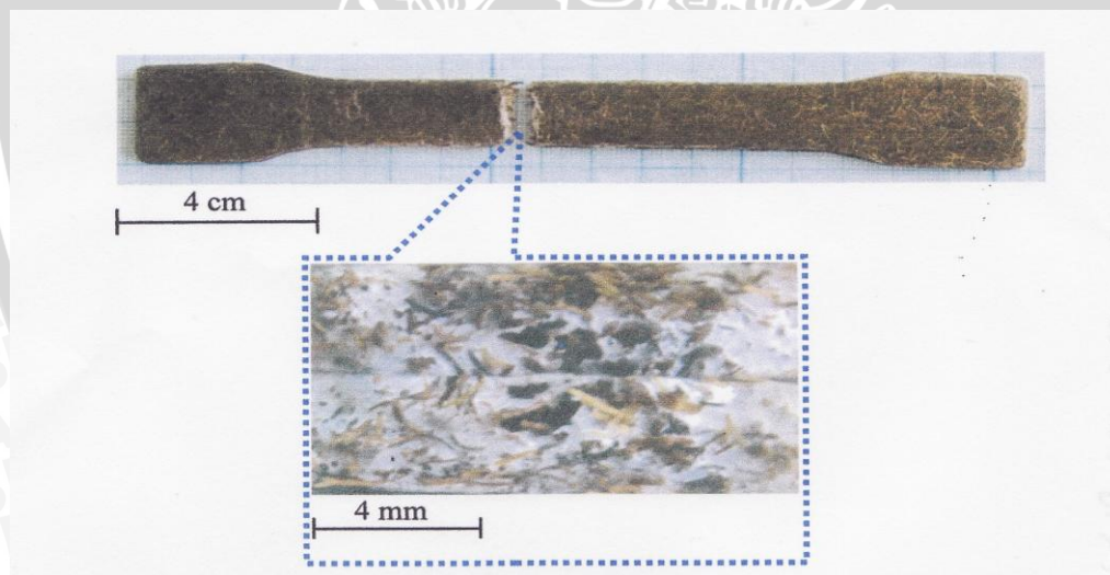
Gambar 2.10. Patahan spesimen uji tarik vraksi volume 50% serat serabut kelapa alkali treatment
