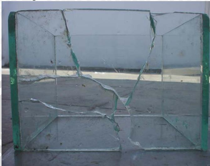
Gambar 4.6. Wadah kaca yang pecah pada pengujian DC sebesar 78,8 kV
