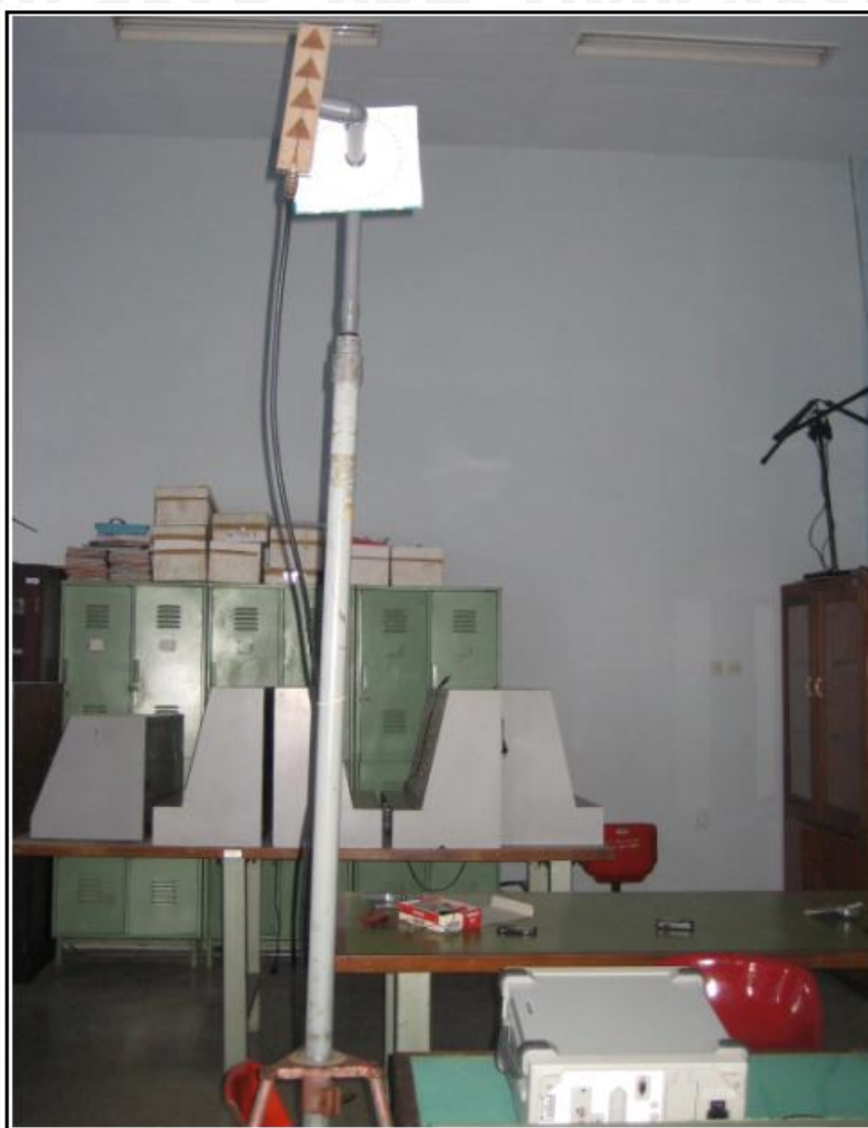
Gambar 29. Antena Mikrostrip Equilateral Triangular Array Sebagai Receiver Pada Pengukuran Polarisasi
