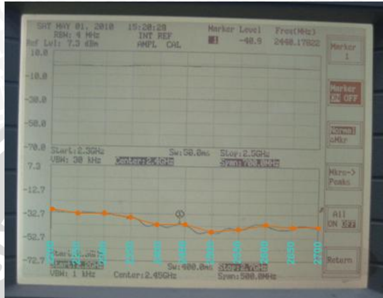
Gambar 5.2 Tampilan Pengujian Return Loss pada Spectrum Analyzer
