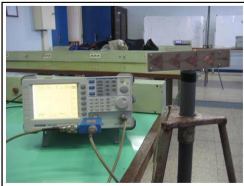
Gambar 25. Antena Mikrostrip Equilateral Triangular Array yang terhubung dengan GW Instek Spectrum Analyzer GSP-827 2,7 GHz Sumber : Pengukuran
