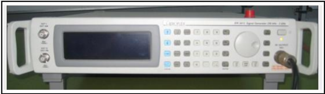
Gambar 27. Signal Generator Aeroflex IFR 3413 250 kHz-3 GHz.
