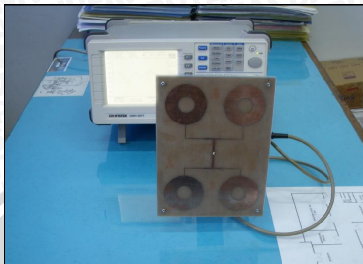
Gambar 33. Antena Mikrostrip Annular Ring Array terhubung dengan GW Instek Spectrum Analyzer GSP-827 2,7 GHz
