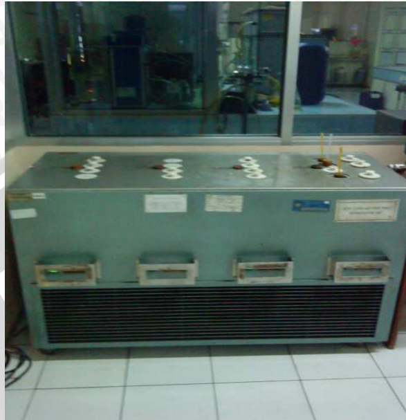
Gambar 3.5 Seta Cloud and Pour Point Refrigeration Unit Sumber : Laboratorium Unit Produksi Pelumas Pertamina Surabaya
