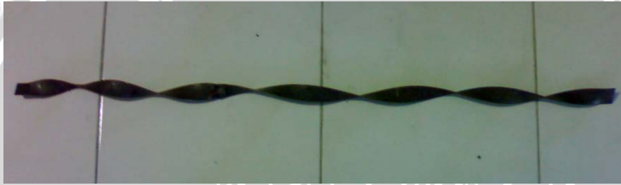
Static twisted tape dengan panjang 800 mm
