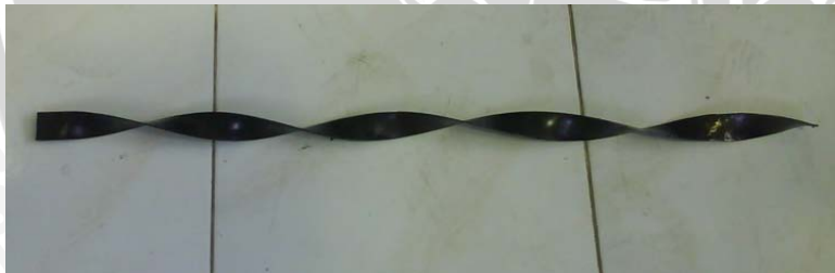
Static twisted tape dengan panjang 600 mm
