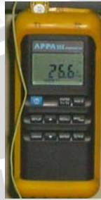
Gambar 3.3 : Digital thermometer dengan thermocouple 2 chanel type K
