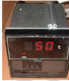
Gambar 3.5 : Thermocontroller dengan thermocouple 1 chanel type K
