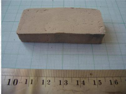
Gambar spesimen uji keausan sebelum dibakar
