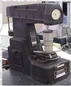
Gambar 2.9 : Mesin Uji Kekerasan *Rockwell*
