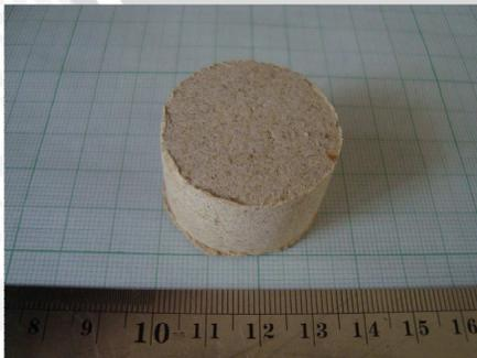
Gambar spesimen uji kekerasan setelah dibakar
