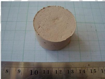
Gambar spesimen uji kekerasan sebelum dibakar
