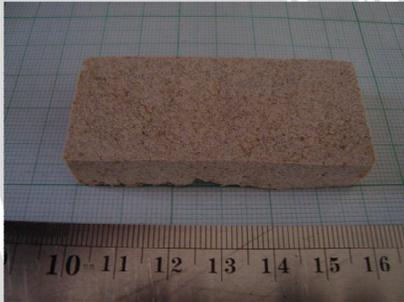
Gambar spesimen uji keausan setelah dibakar
