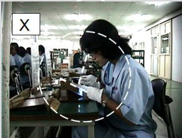
Gambar 4.2 Sudut Pandang Cara Melihat Reed Pada Reed Plate yang Salah (sudut lebih besar/kecil 90^\circ )
