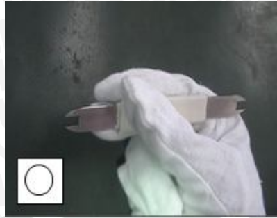
Gambar 4.3 Cara memegang Spanner dengan Benar Sumber: Dokumen KK PT.YMPI, 2008
