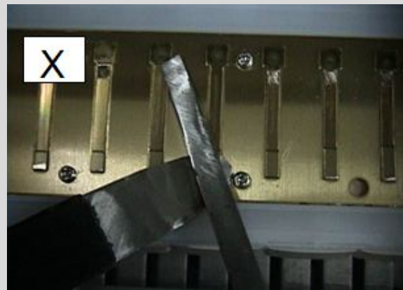
Gambar 4.11 Posisi Pengikiran dengan Arah Kikir Miring Sumber: Dokumen KK PT.YMPI, 2008
