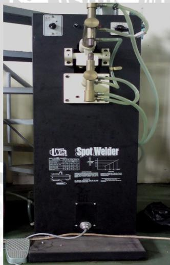
Gambar 3.2 Mesin Las Titik
