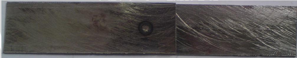
Gambar 4.1 Hasil Pengelasan Titik
