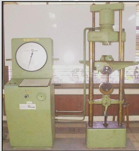
Gambar 3.3 Mesin Pengujian Geser
