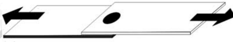
Gambar 2.8 Skema Pengujian Geser
