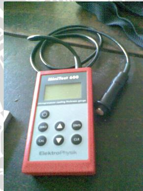
Gambar 2.3. *Coating thickness mini Test 600 Type* : 12-1605 SN: 9802.
