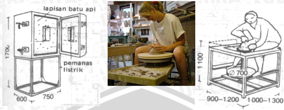
Gambar 2.16 Ukuran dapur pembakaran keramik dan roda pengolah keramik Sumber : Neufert (2003:137)
