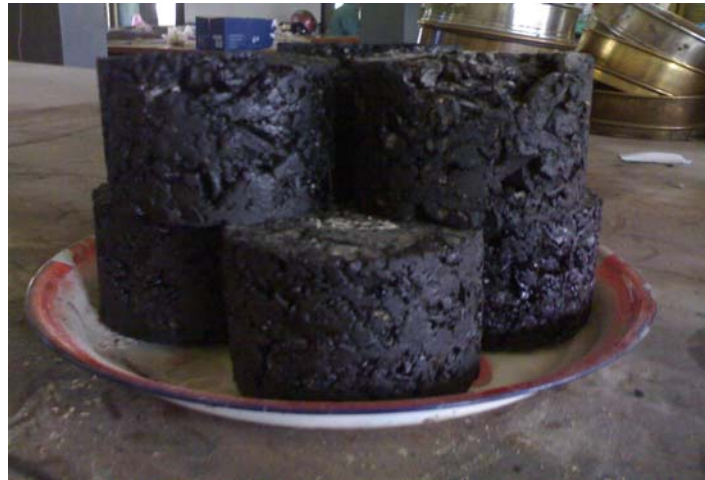
Gambar 22. Keadaan Benda Uji Setelah Test Marshall
