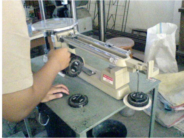
Gambar 5. Pengujian Berat Jenis Agregat Kasar
