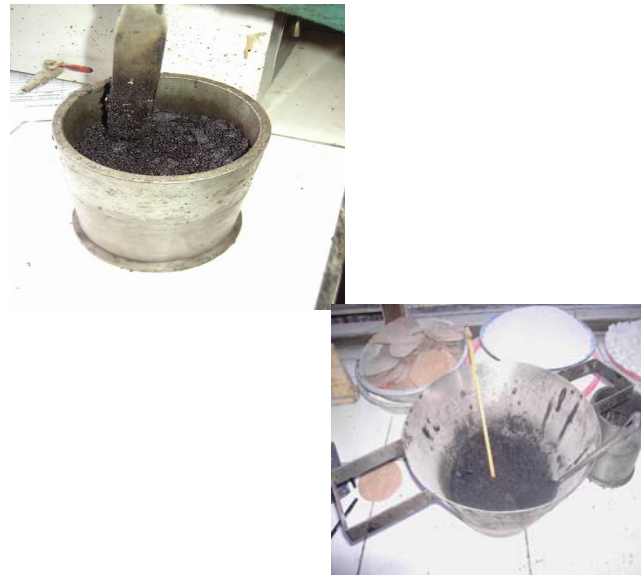
Gambar 18. Pemeriksaan Temperatur Sebelum Pemadatan dan Penusukan Adonan Campuran Aspal
