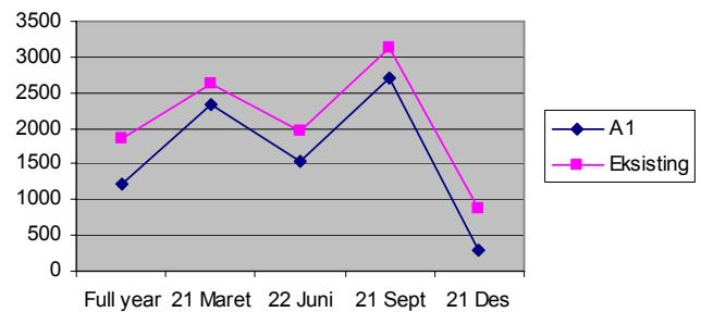
Dinding Utara 3 merupakan dinding core yang tidak memiliki jendela sehingga tidak ada shading atau treatment khusus. Perubahan nilai solar insolation ini disebabkan karena pengaruh shading yang ada di dinding barat2.
