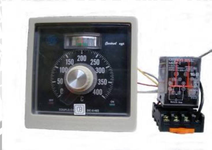
Gambar 3.3. *Thermocontrol dan Relay*
