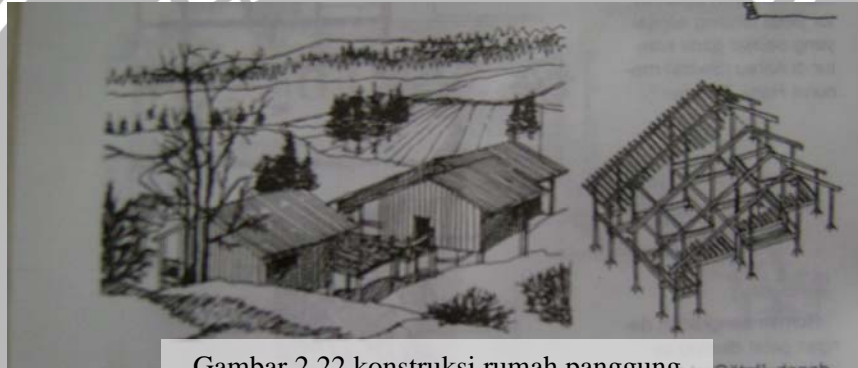
Gambar 2.22 konstruksi rumah panggung Sumber : Heinz Frick, 20003
