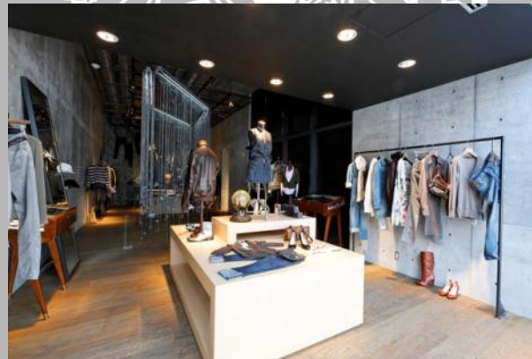
Gambar 2.4.6. Pencahayaan Downlight (lampu tanam pada plafond) Sumber: www.shift.jp.org
