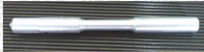
Gambar 3.6 Spesimen Uji Tarik.
