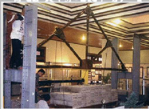
**Gambar 64.** Pengujian konstruksi jembatan bambu
