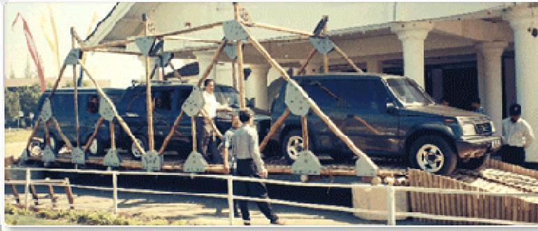
**Gambar 63.** Pengujian konstruksi jembatan bambu
