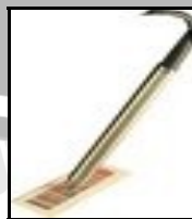
Gambar 2.18. Barcode reader berbentuk pena atau tongkat
