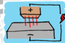
Gambar 2.2 Komponen Dasar Mesin EDM Sumber : www.charmilles.com/edm principle
