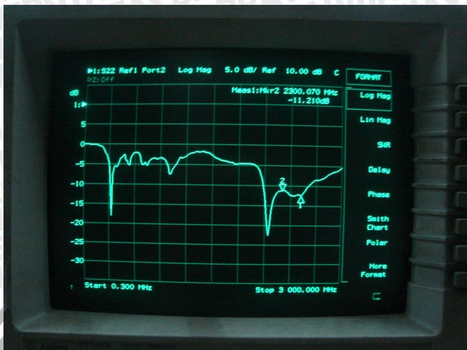
Hasil Pengukuran *Return Loss Rectangular Dual* Frekuensi pada Rentang 300KHz – 3GHz
