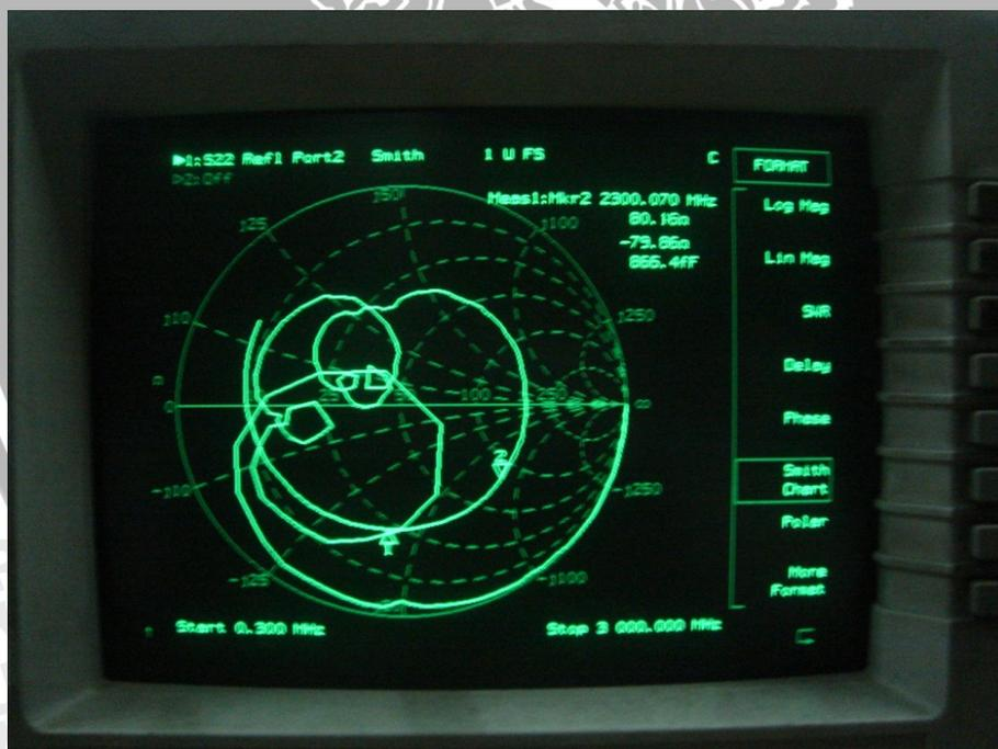
Hasil Pengukuran Impedansi Antena *Rectangular Single* WLAN Rentang 300KHz – 3GHz
