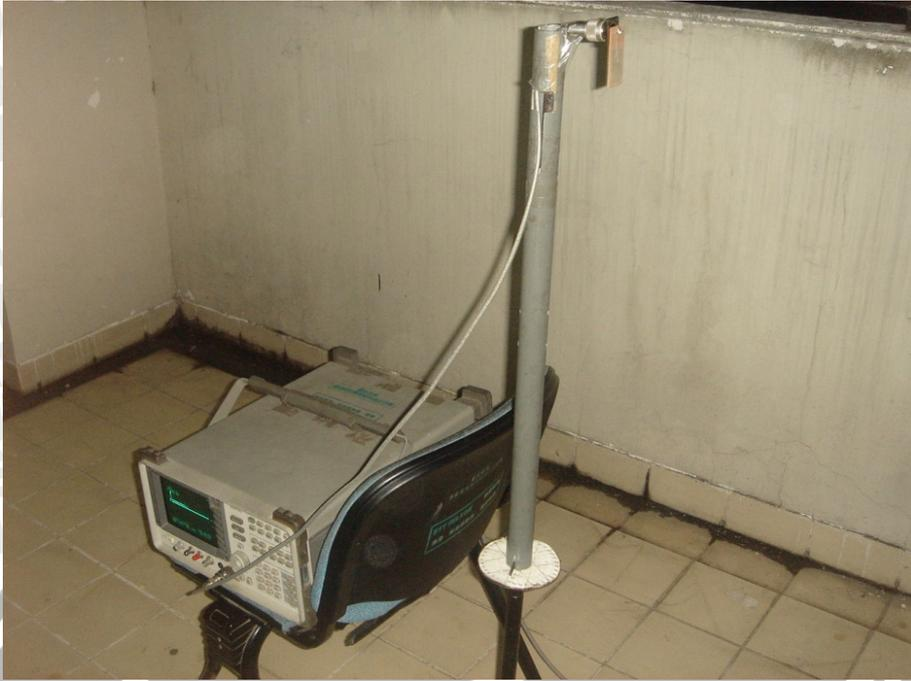
Rangkaian antena mikrostrip pada sisi penerima pada pengukuran *outdoor*
