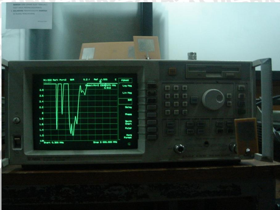
Antena Mikrostrip *Rectangular Single* WLAN yang terhubung dengan *Agilent RF Network Analyzer 8714ES* 300KHz – 3GHz
