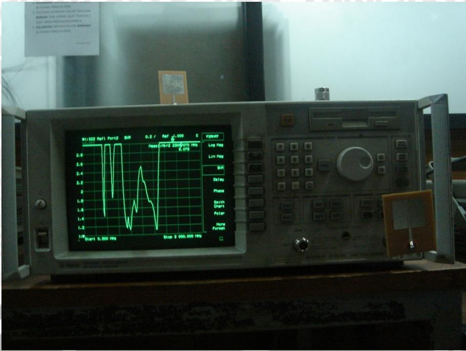
Antena Mikrostrip *Rectangular Single* Wi-MAX yang terhubung dengan *Agilent RF Network Analyzer 8714ES* 300KHz – 3GHz
