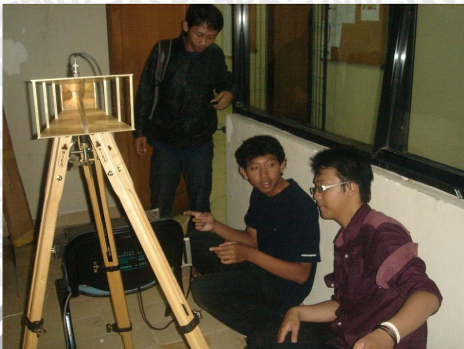
Antena Horn yang digunakan pada sisi pemancar pada pengukuran *outdoor*
