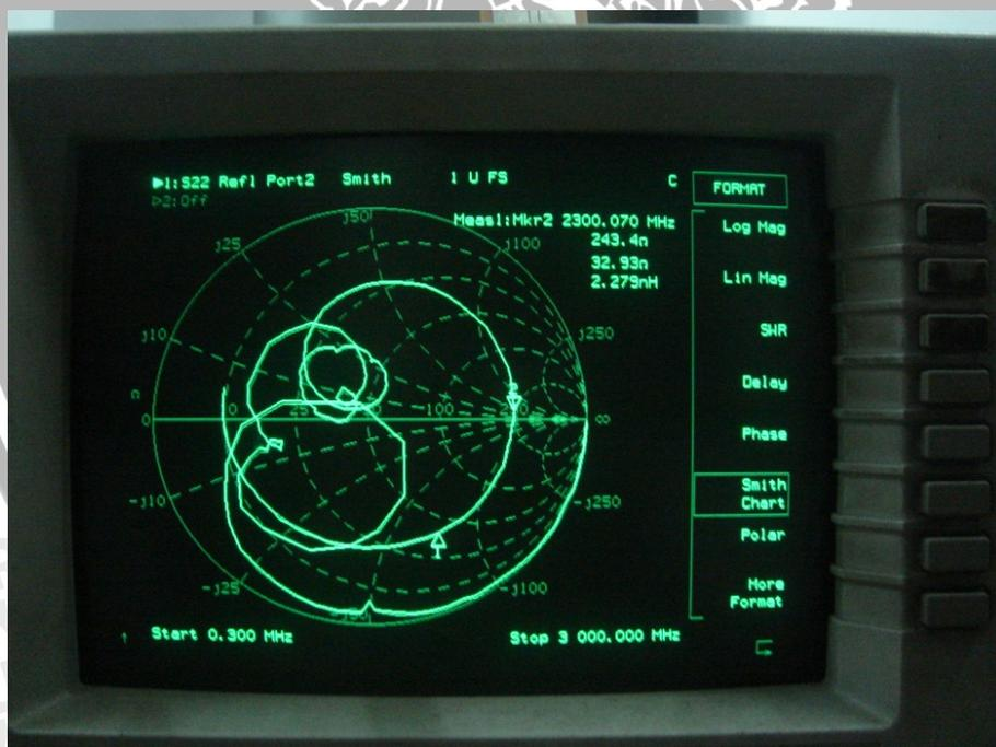
Hasil Pengukuran Impedansi Antena *Rectangular Single Wi-MAX* pada Rentang 300KHz – 3GHz
