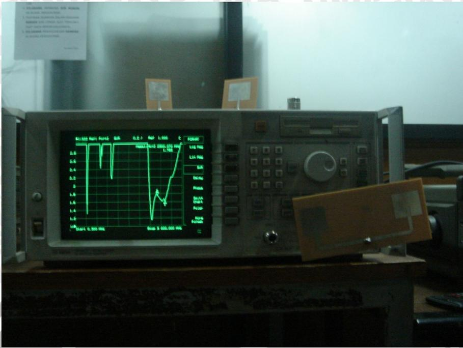
Antena Mikrostrip *Rectangular Dual* Frekuensi yang terhubung dengan *Agilent RF Network Analyzer 8714ES* 300KHz – 3GHz
