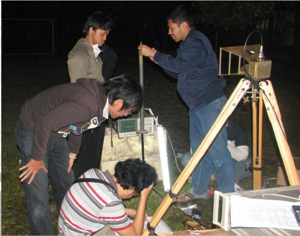
Proses pengukuran *gain*, pola radiasi dan polarisasi
