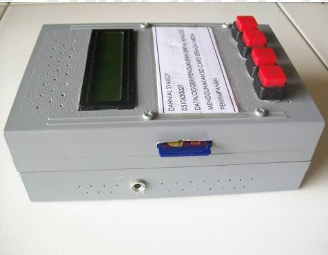
Gambar 2 Tempat SD card dan port tegangan referensi sebesar 3,44 V untuk sistem eksternal
