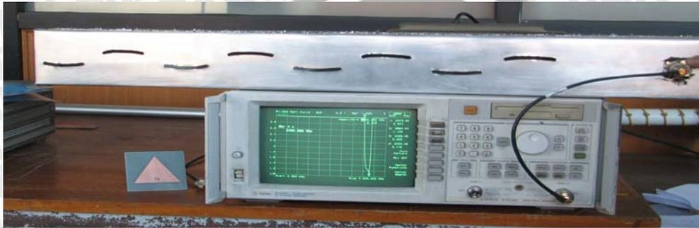
Gambar 17. Antena *Waveguide Slot* yang terhubung dengan *Agilent RF Network Analyzer 8714ES 300KHz – 3GHz*
