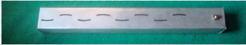
Gambar 16. Antena *waveguide slot* dengan *banana array*
