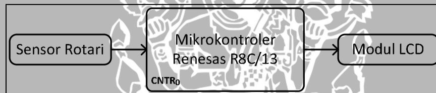
Gambar 5.4. Diagram blok pengujian jumlah pulsa sensor rotari.
