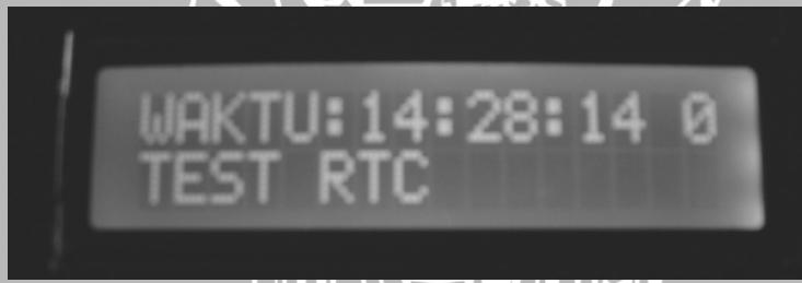
Gambar 5.5. Foto Hasil Pengujian Rangkaian RTC DS1307
