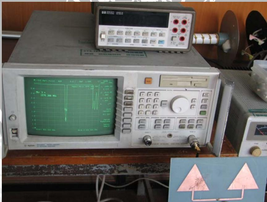
Gambar 18. Antena Mikrostrip *Equilateral Triangular Array* yang terhubung dengan *Agilent RF Network Analyzer 8714ES 300KHz – 3GHz*
