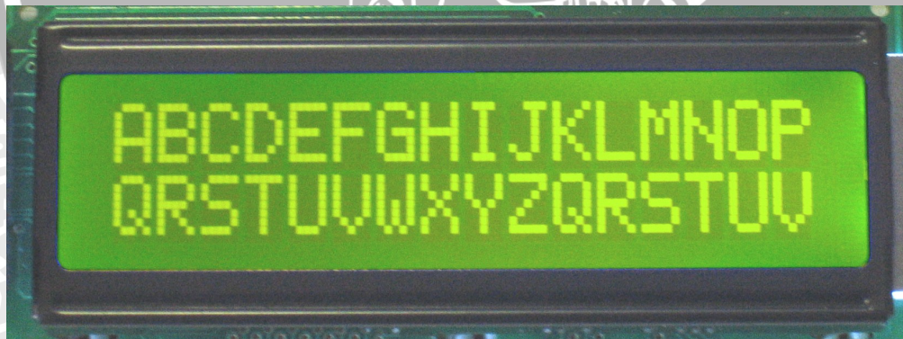
Gambar 5.4 Hasil Pengujian Perangkat Keras Modul 3. LCD Character
