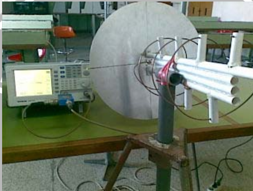
Gambar 5.11 Konfigurasi Pengujian VSWR dan Return Loss
