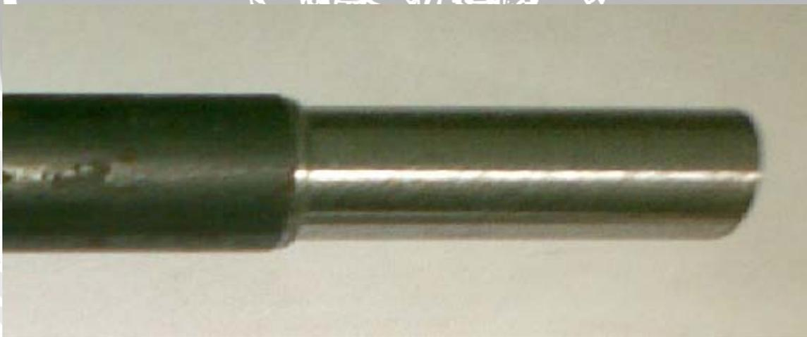
Gambar 2. Spesimen hasil pembubutan
