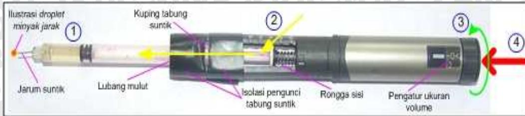
Gambar 3.7 Alat pembentuk *droplet* minyak kelapa
